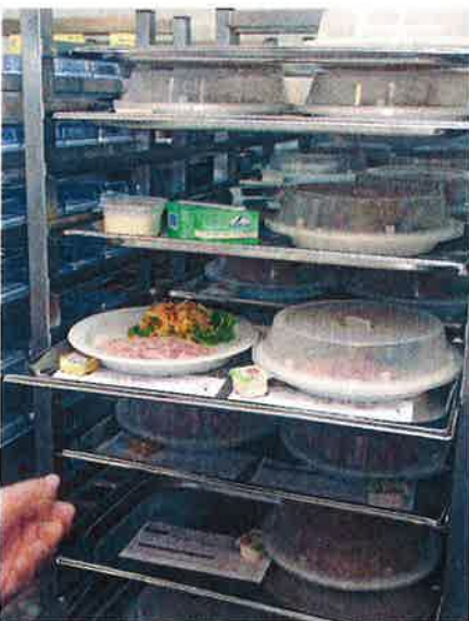
Geschirrkühlung und Akkus im Transportwagen stellen sicher, dass die kalten Speisen kühl bleiben.
